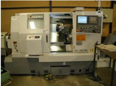
Drehmaschine „Goodway GS-280“ Baujahr 2004
